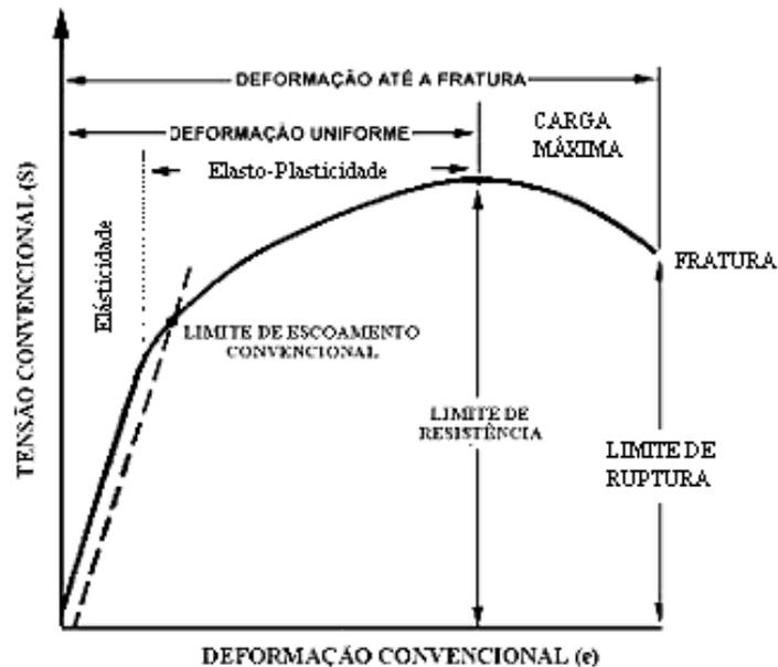
Figura 1 - Curva tensão-deformação de engenharia [6].
