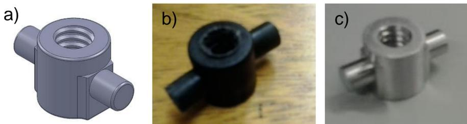
Figura 1. Peça modelada em 3D (a), Peça original extrudada (b) e peça usinada (c)
