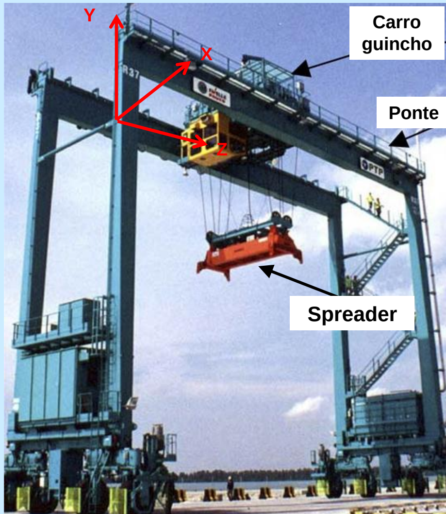
Porta container sobre rodas e seus principais componentes
